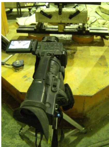
Figura 3.36. Filmadora utilizada para filmar a superfície de fratura dos corpos-de-prova.
