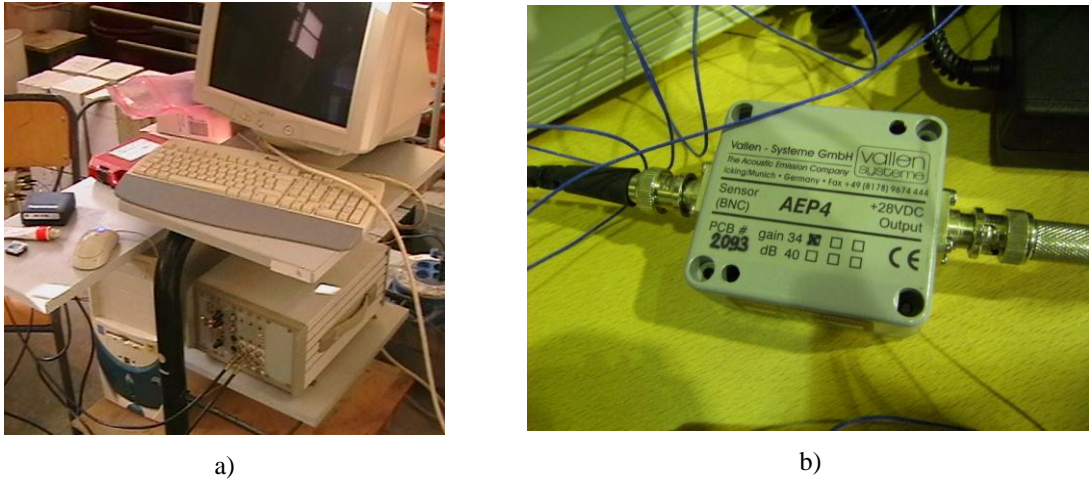
Figura 3.34. (a) equipamento de EA, AMSY-5 M6 (b) pré-amplificador.
