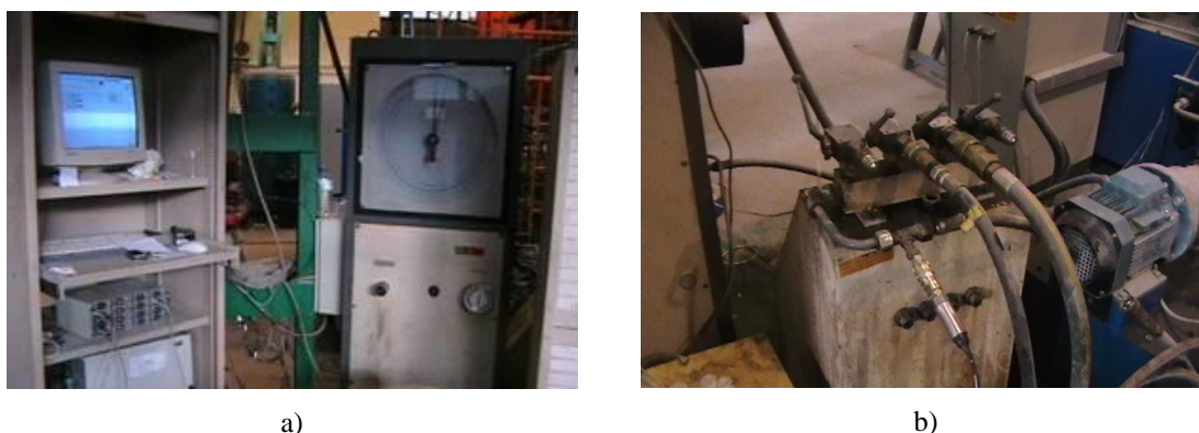
Figura 3.33. (a) sistema manual de aplicação de carga à direita e conjunto sistema de aquisição de dados/computador à esquerda (b) mecanismo de direcionamento do fluxo de óleo, permite a escolha do pórtico a ser utilizado.
