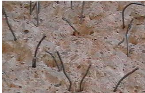
Figura 4.56. Superfície fraturada mostrando fibras retificadas por arrancamento.
