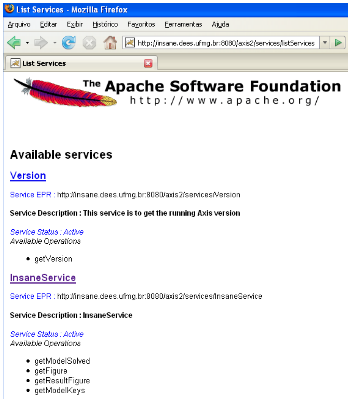
Figura 6.9: Confirmação da instalação ( deploy ) do InsaneService .
