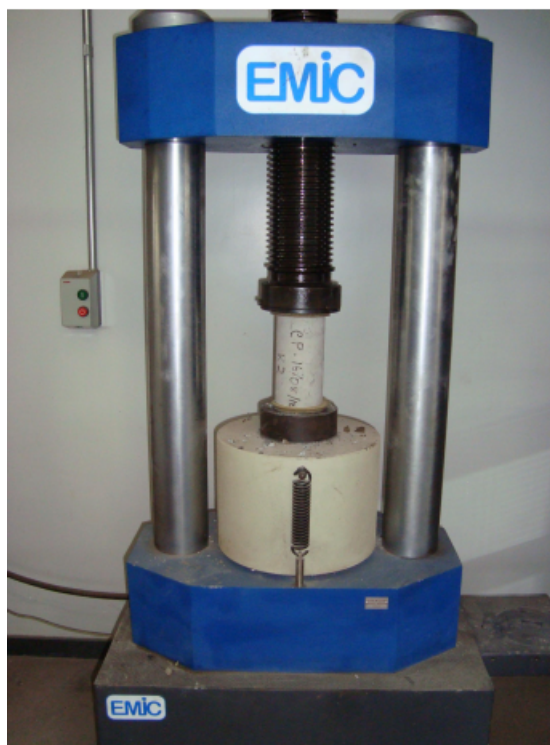
Figura 6.1: Ensaio de compressão axial (Andrade, 2015).
