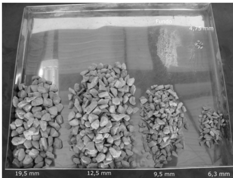
Figura 4.2: Agregado graúdo diferentes diâmetros ( Andrade, 2015 ).
